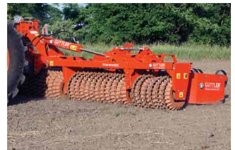
Die Frontpackerwalzen liefert Güttler als Einzel- oder Doppelwalzen, mit oder ohne vorlaufende Federzinken.
