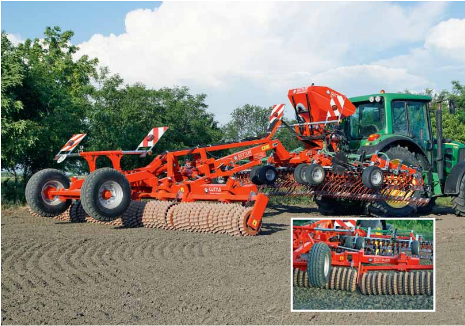
Im Bereich Grünlandpflege und -nachsaat sieht Güttler noch viel Potenzial. Striegel und Walze lassen sich auch solo einsetzen. Bei der Masterwalze sind die Elemente pendelnd aufgehängt.
