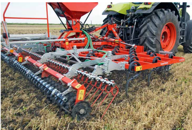
2007 bringt ausgerechnet der Walzenspezialist ein Gerät ohne Walze auf den Markt, den Federzinken-grubber SuperMaxx. Mit seinen schmalen Scharen soll er feuchte Böden aufreißen und ablüften. Er wird zur Stoppelbearbeitung und zur Saatbettbereitung eingesetzt. Die Anbaugeräte sind fünf-, die aufgesattelten Geräte siebenbalkig. Arbeitsbreiten bis zwölf Meter sind verfügbar. Mittlerweile wird der SuperMaxx serienmäßig mit der Walze Rollfix ausgeliefert. Der Druck auf die Walze ist variabel von null bis 100 Prozent einstellbar. Ab Modelljahr 2016 ist der SuperMaxx auch mit Säaggregat für die Zwischenfruchtbestellung lieferbar.
